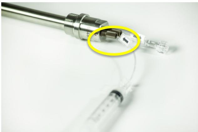
Abbildung 15: Füllen der Sonde mit Pufferlösung
