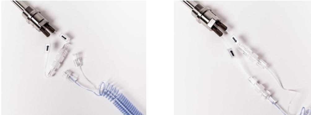
Abbildung 17 und 18: Anbindung der Dialyse-sonde an das Schlauchset
