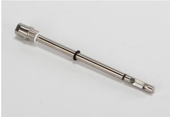
Abbildung 14: Einlegen der Gleitscheibe und O-Ring
