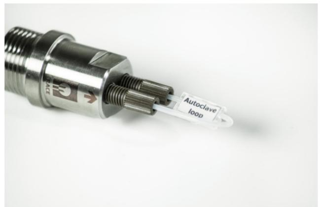
Abbildung 16: Verschließen der Sonde vor dem Sterilisieren
